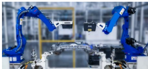
某大型汽车零部件厂 副车架在线测量
