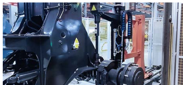
某大型工程机械厂 视觉引导高精度螺栓拧紧
