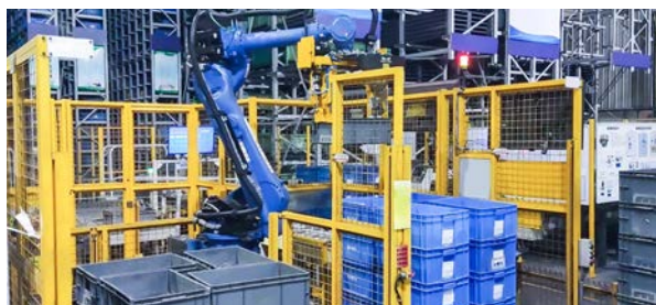
某大型汽配厂 视觉引导周转箱拆垛
